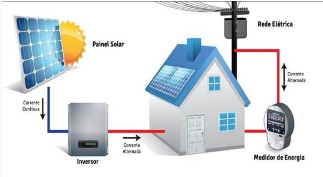
Figura 3 - Esboço de sistema fotovoltaico conectado à rede de distribuição de energia elétrica.
