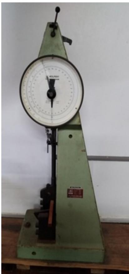
Obteve-se, por meio desse ensaio, o trabalho absorvido ( $W$ ) para fraturar o corpo-de-prova (Figura 3.)
