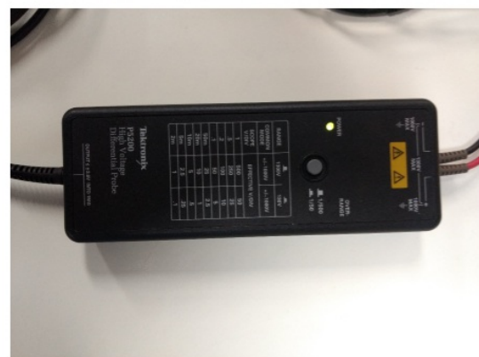
Figura 4 - Ponteira Agilent 1146A utilizada para mensurar a corrente alternada e ponteira Tectronix P5200 utilizada para mensurar a tensão
