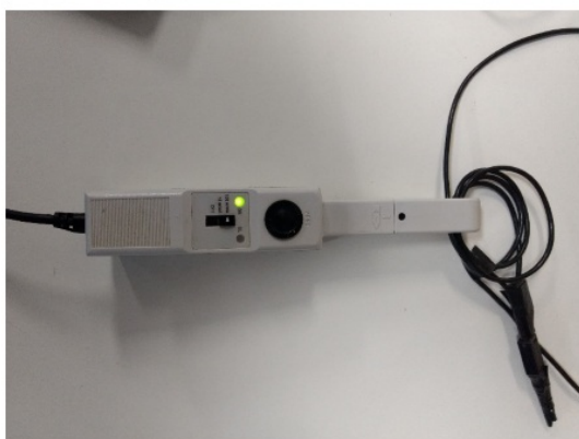
Figura 4 - Ponteira Agilent 1146A utilizada para mensurar a corrente alternada e ponteira Tectronix P5200 utilizada para mensurar a tensão
