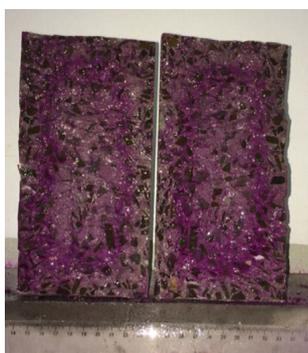
Figura 1: Carbonatação do concreto referência
