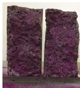
Figura 2: Carbonatação do concreto com substituição de 5%
