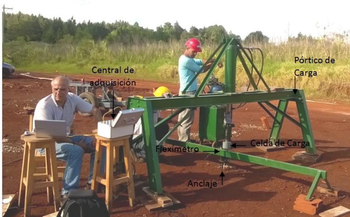
Figura 1: Equipamiento y ejecución de ensayo de extracción en campo.
