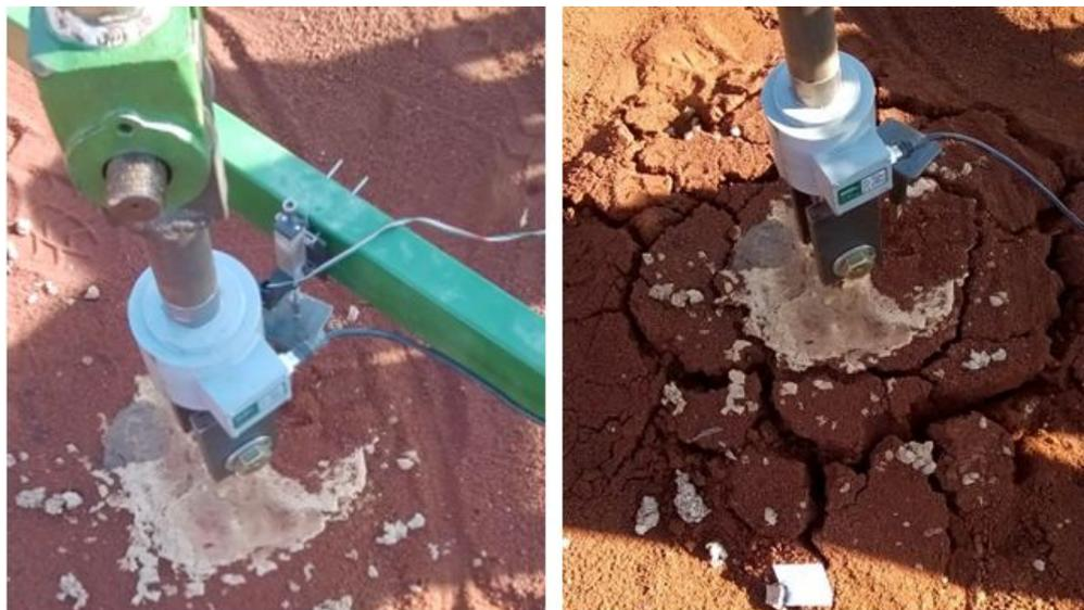
Figura 2: Detalhe Fijación de Celda y Flexímetro. Resultado extracción anclaje en campo hasta rotura.
