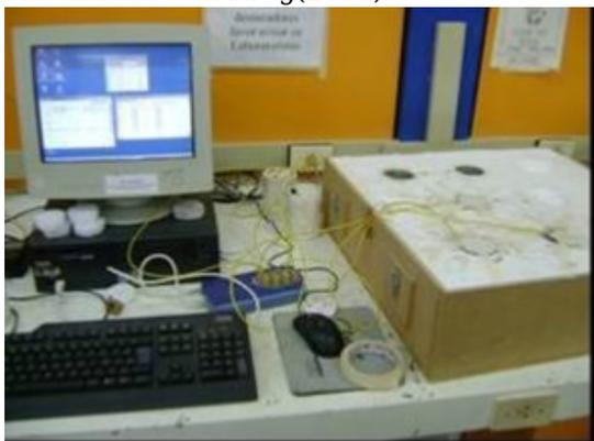
Figura 1 - Equipamento de calorimetria Semi-adiabática
