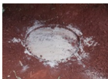
Figura 3: Ruptura por punção
