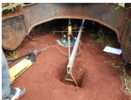
Figura 1. Realização do ensaio de placas
