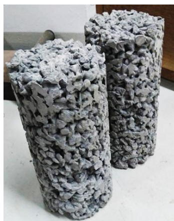
Figura 2. Copo de prova de concreto permeável
