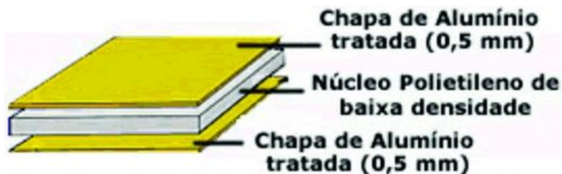
Composição da chapa de ACM – Alumínio Composto
