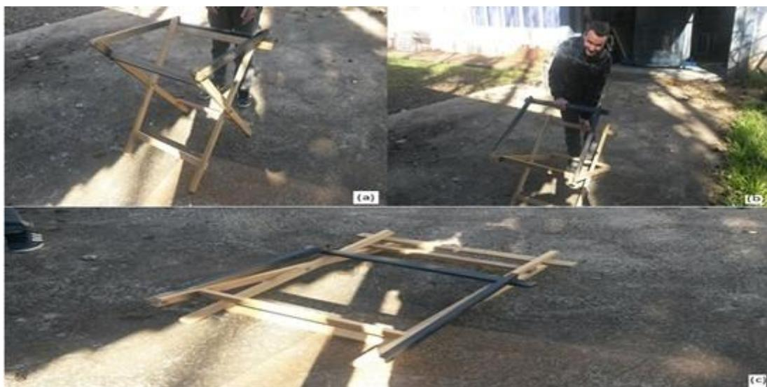
Figura 2: Essa figura mostra a sequencia que se deve ser feita para se guardar a mesa seguindo a ordem de (a), (b) e (c).
