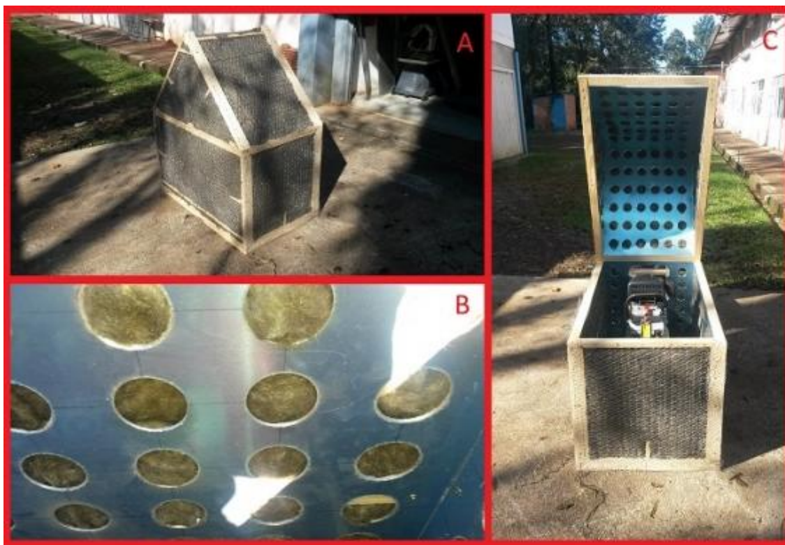
Figura 1: (A) Modelo finalizado parte exterior; (B) Furação das chapas de alumínio; (C) Modelo finalizado parte interna.
