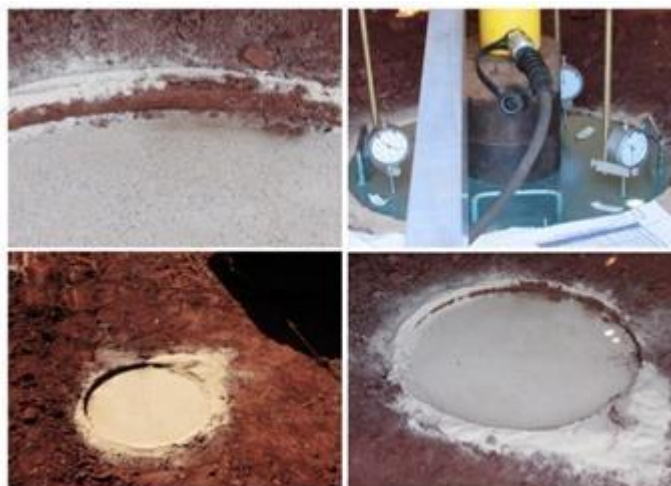
Figura 3 - Ruptura do solo na placa de 48 cm
