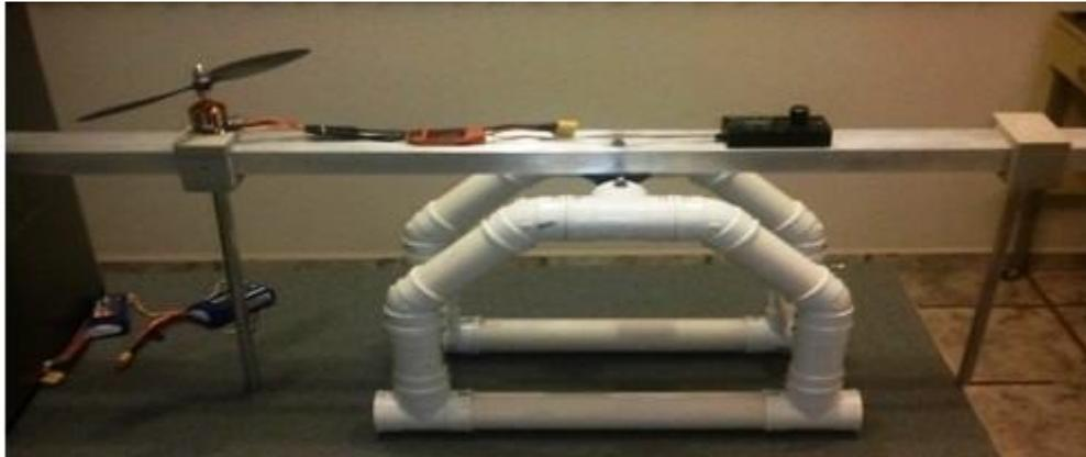
Figura 2. Plataforma de testes para o conjunto motores brushless-hélice
