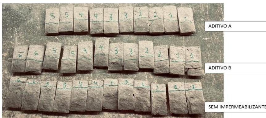
Figura 3 - Corpos de prova por ascensão capilar. Fonte: Autores
