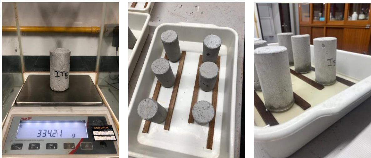
Figura 2: Pesagem da massa de água. Fonte: Autores.
