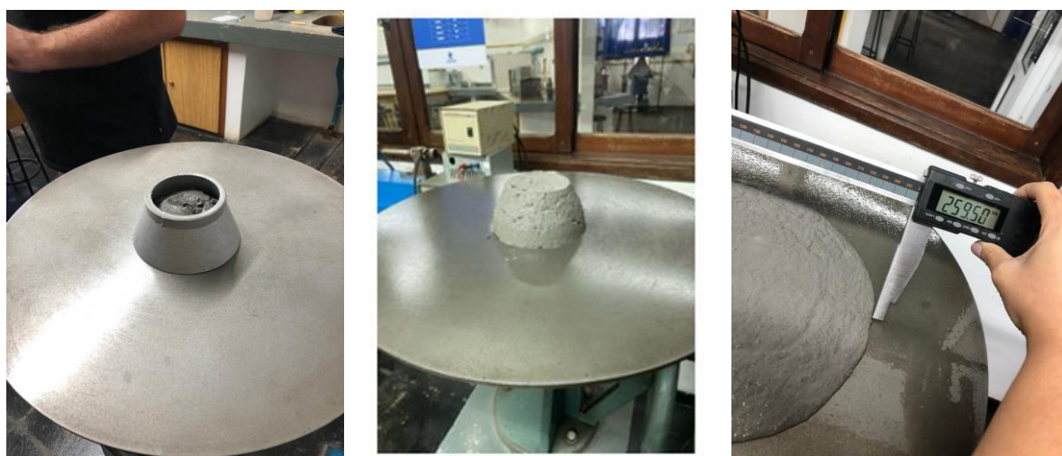
Figura 1: Espalhamento da argamassa. Fonte: Autores.
