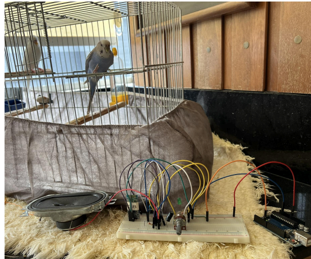
Figura 6 - Dispositivo ultrassônico em protoboard arranjado em frente da gaiola. Fonte: Autores (2024).
