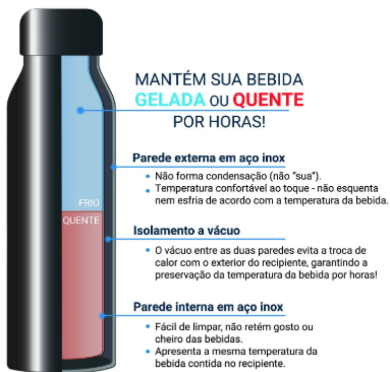
Figura 1 - Garrafa térmica a vácuo de parede dupla. Fonte: Google (2024).
