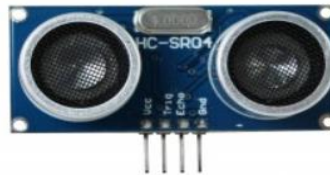
Figura 2. Sensor ultrassônico modelo HC-SR04.
