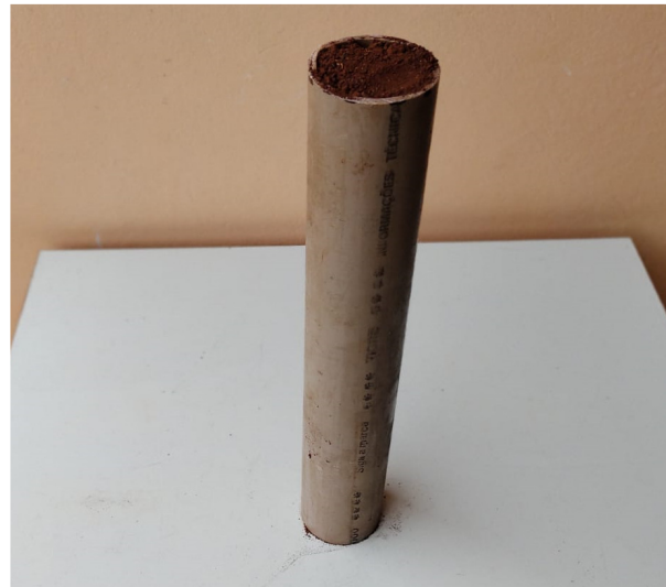
Figura 3 – Bancada de teste do ângulo de repouso do solo
