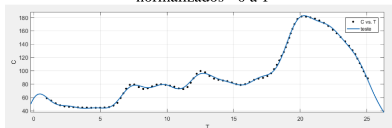
Figura 7. Função Sum of Sine, comparativo com vetor não normalizado com dados normalizados - 0 a 1
