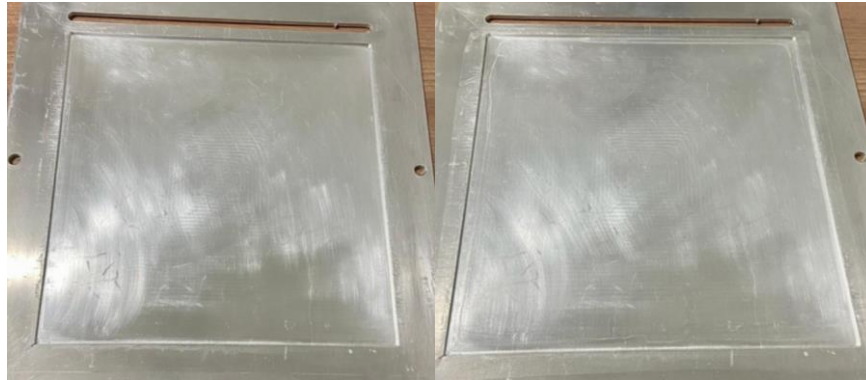
Figura 3 – Início do Processo de Deposição com a Limpeza da Matriz (a) e Revestimento com Lâmina de PVC Autoadesiva (b).
