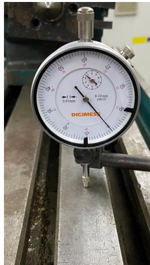
Figura 8 – Verificação da planicidade superficial da mesa da furadeira-fresadora.
