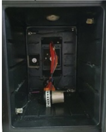
Figura 3 – Sistema de aquecimento e sensores de temperatura.
