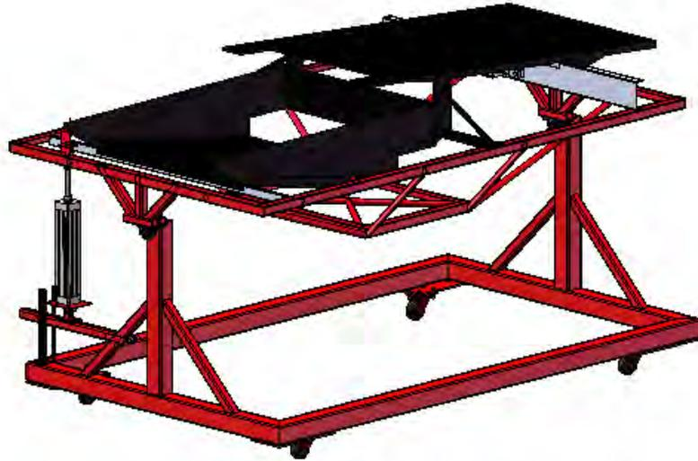
Figura 3 – Projeto da bancada realizado com software de CAD com as peneiras (em preto) já posicionadas para teste.
