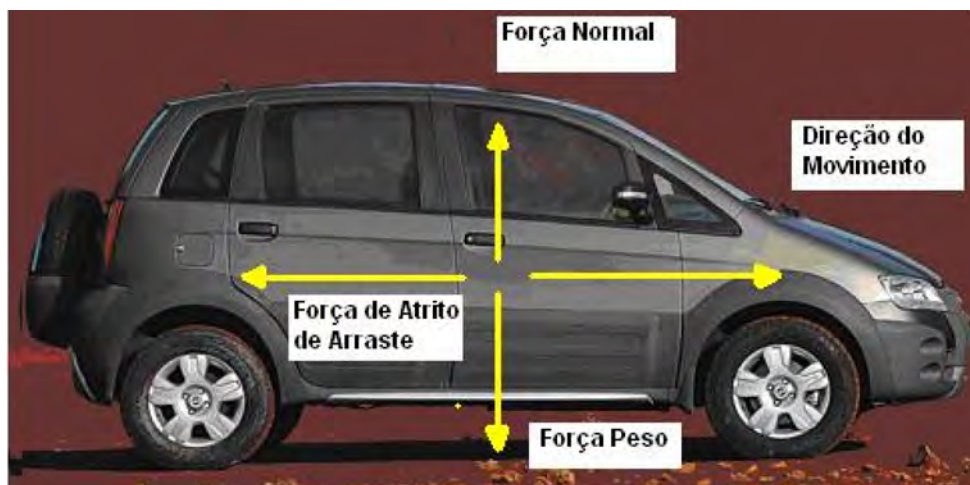
Figura 1 - Forças atuantes no movimento do veículo.
