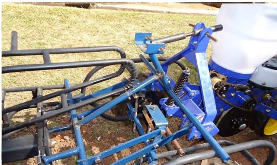
Figura 5. Foto do protótipo do acoplamento 3 pontos entre o microtrator e a semeadora.
