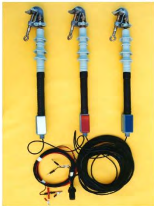
Figura 1 – Transformador de Potencial (TP) da MRL
