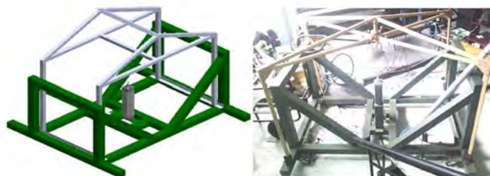
Figura 1 - Vista tridimensional da bancada e a foto do protótipo construído.
