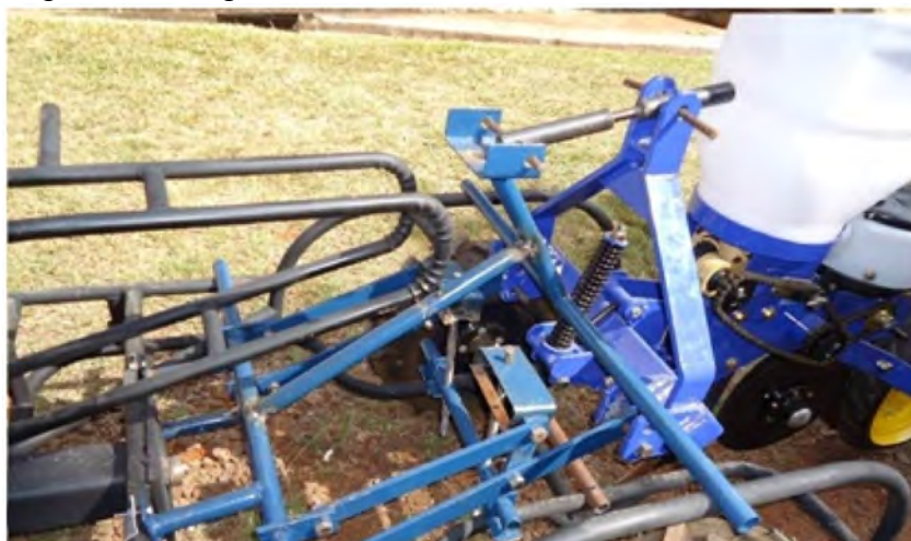
Figura 2. Foto do protótipo do acoplamento 3 pontos entre o microtrator e a semeadora.
