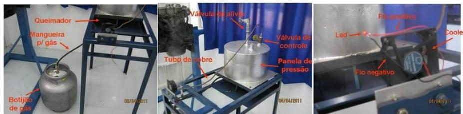
Figuras 6 – Componentes do gerador de vapor
