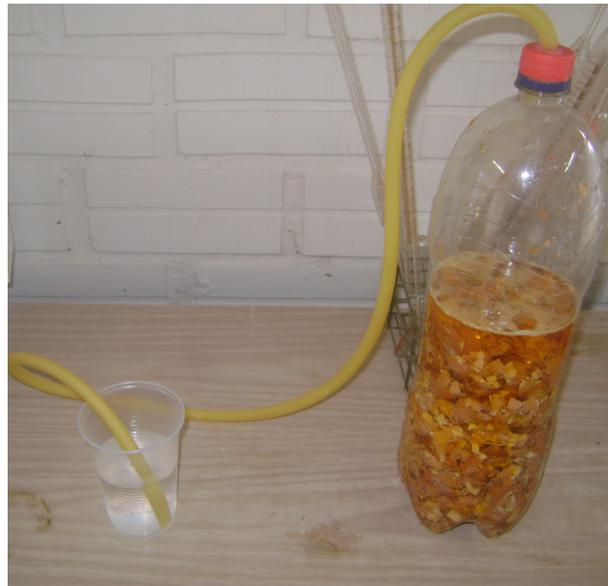
Figura2. Sistema depois de ocorrer à reação (garrafa pet com cascas de ovos e vinagre, liberou gás que ao borbulhar tornou a solução incolor).
