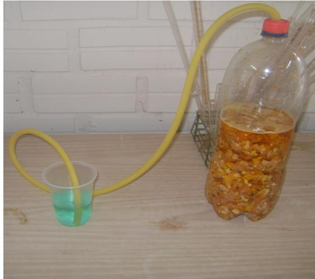
Figura 1. Sistema pronto antes de começar a reação (garrafa pet com cascas de ovos e vinagre, liberação de gás carbônico que borbulha no copo contendo NaOH e indicador).
