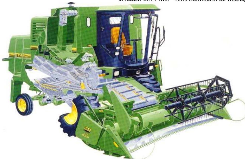
Figura 1- Detalhe (em branco) de uma colheitadeira onde se realiza o processo de separação dos grãos.
