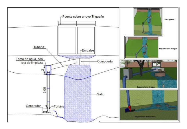
El diseño se compone de un embalse, y un canal que se proyectó para ser de tubos, funcionará como un canal, pero cerrado. De no ser de esta manera, podría suceder que tanto ramas como otros desechos podrían llenar el canal y terminar en la cámara de carga (que sirve para asegurar un caudal mínimo en la turbina).
