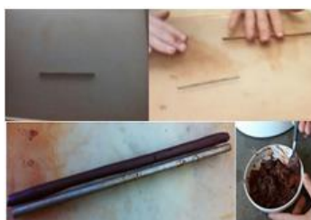
Figura 2: Ensaio de Limite de Plasticidade, solo Santa Rosa e Santo Cristo
