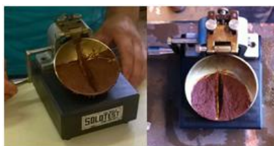
Figura 1: Limite de Liquidez solo Santa Rosa e Santo Cristo, respectivamente.
