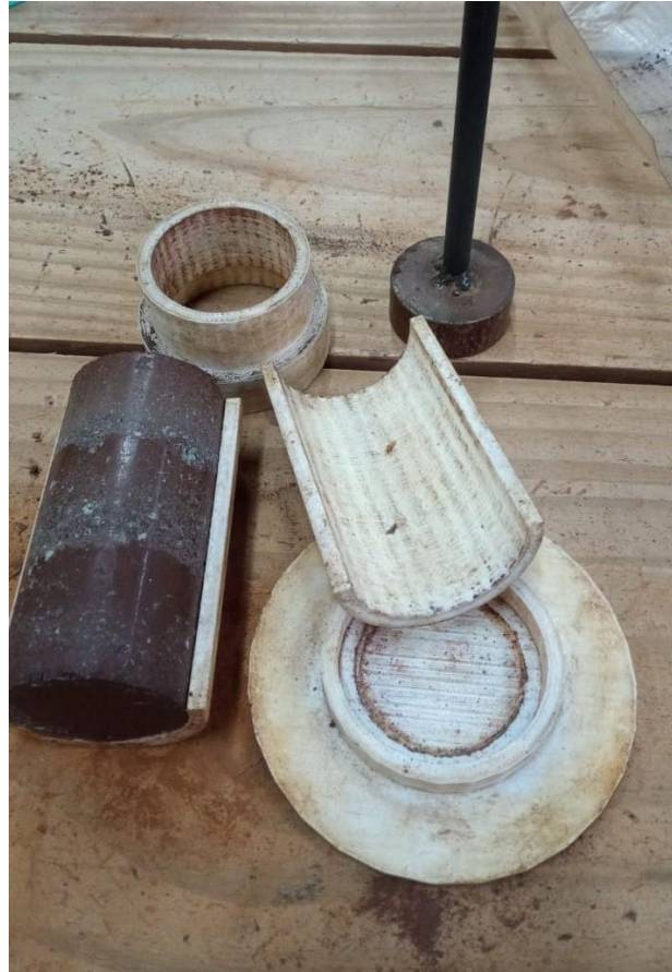
Figura 1 – Molde especial (bipartido) para moldeo de probetas a ensayar
