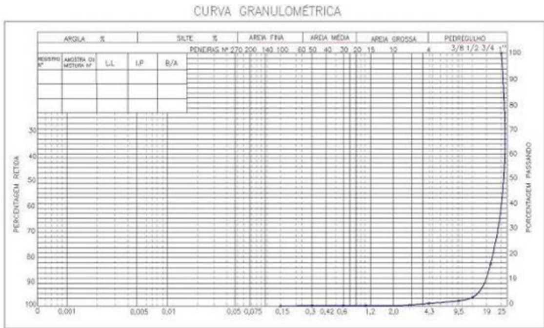
Figura 02 - Curva granulométrica da brita 1
