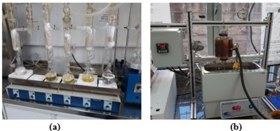
Figura 1. Equipamentos para extração de óleo do farelo de arroz. (a) extração utilizando hexano e (b) extração utilizando CO2 supercrítico.
