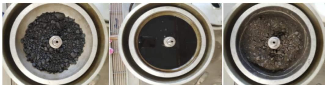
Figura 1: Ensaio laboratorial de Extração de betume
