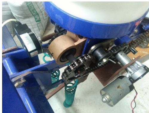
Figura 1 - Montagem do encoder incremental no eixo do dosador
