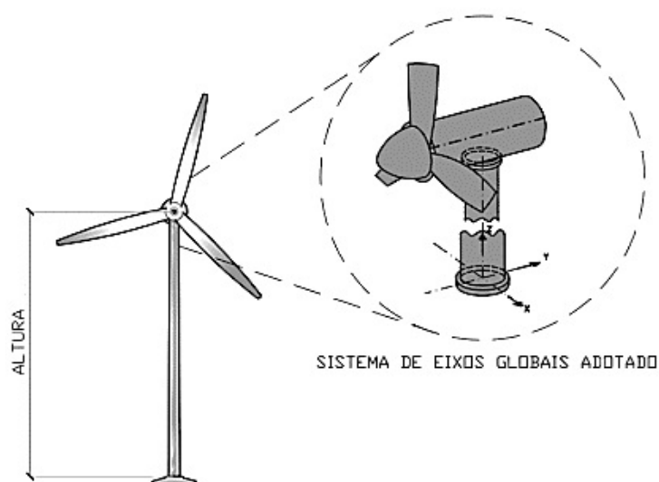
Figura 4 - Sistema de Eixos adotado para Turbinas Eólicas
