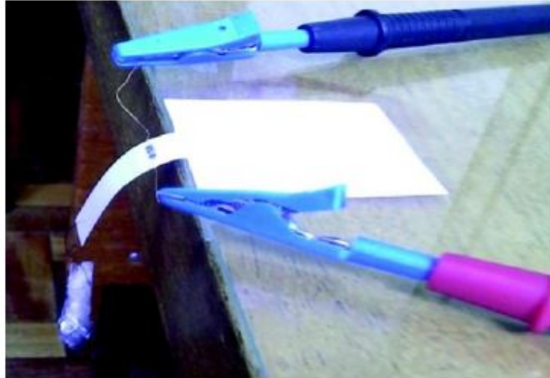
Figura 5 - Arranjos experimentais da obtenção da piezoresistência submetida a diferentes tensões mecânicas
