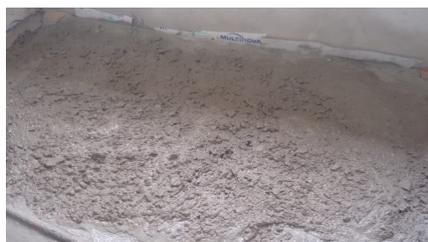
Figura 2: argamassa feita a partir do agregado reciclado.
