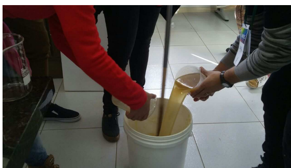
Figura 1: óleo de cozinha sendo misturado a soda dissolvida.
