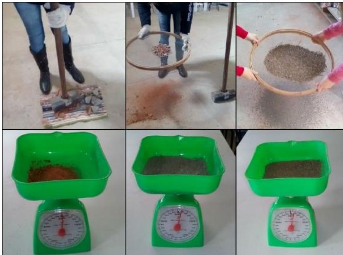
Figura 02: Passo a passo da produção do tijolo de resíduos;
