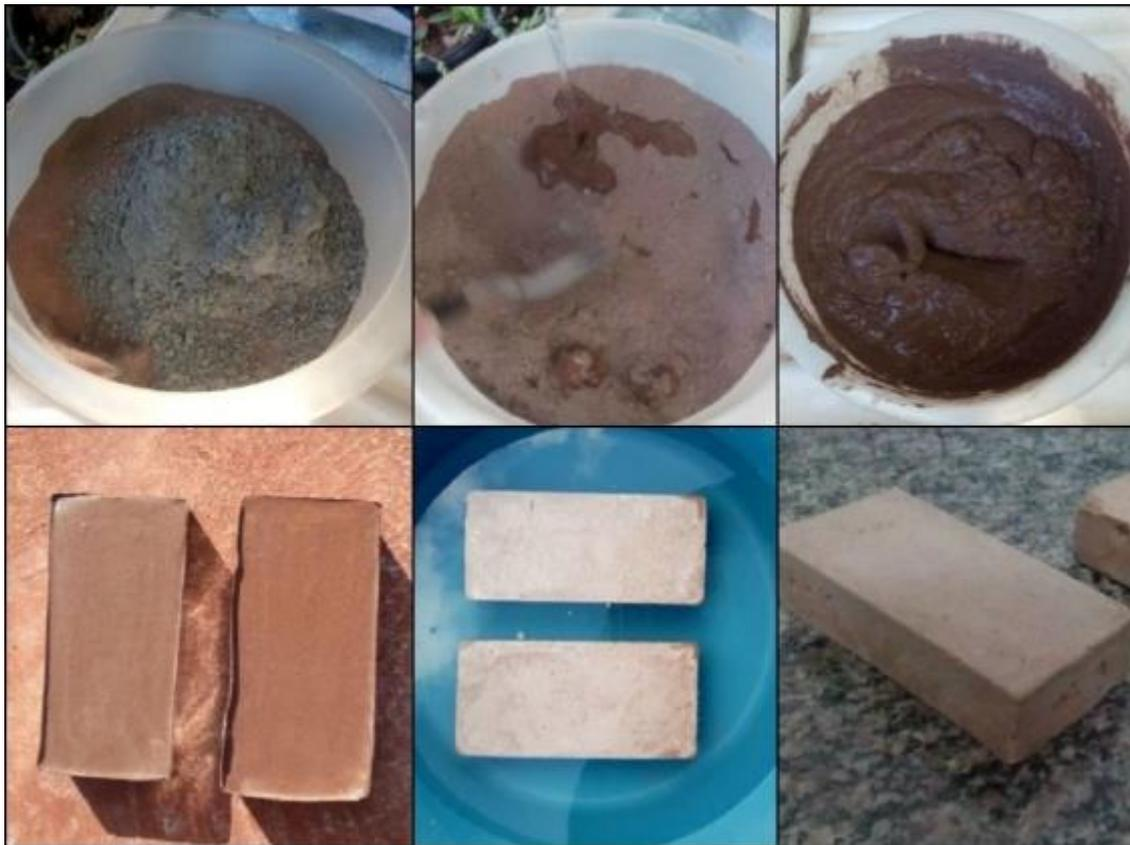
Figura 03: Passo a passo da produção do tijolo de resíduos;
