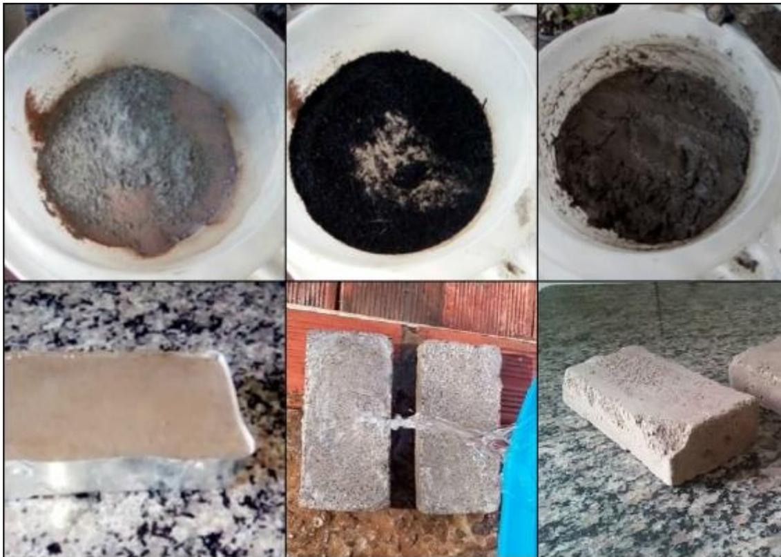
Figura 05: Passo a passo da produção do tijolo de resíduos e grânulos de borracha de pneus;
