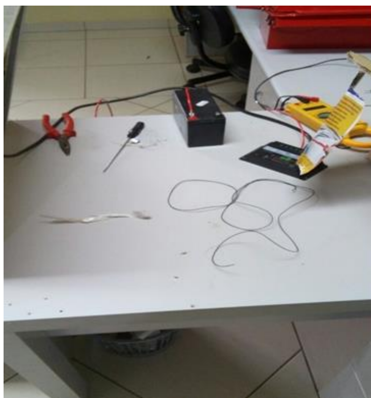
Figura 07: Ligação dos fios da bateria e dos LEDS no controlador de carga. Fonte: Própria.
