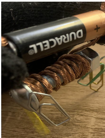
Figura 2: Eletroímã com uma corrente elétrica e um campo magnético.
