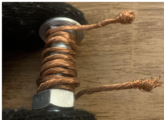
Figura 1: Eletroímã sem uma corrente elétrica e sem um campo magnético.
