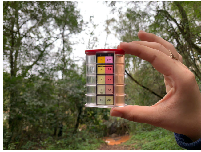
Figura 2 - Medição de pH da água do Rio Potiribu.
