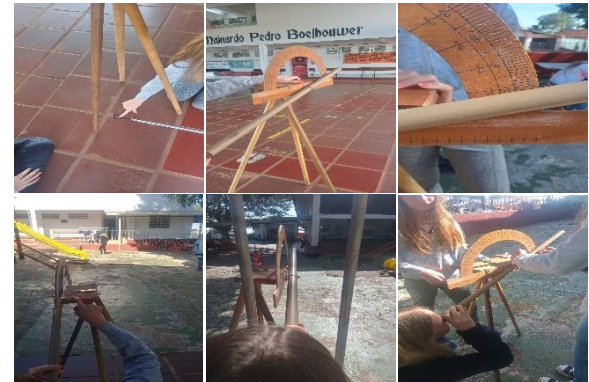
Encontrando a altura com o Teodolito Fonte: Autores (2022)
