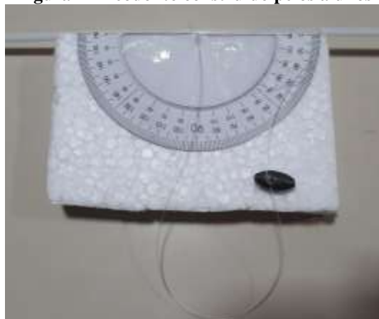
Figura 1 - Teodolito construído pelos alunos
