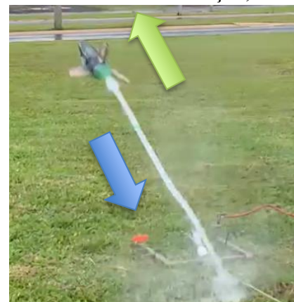
Figura 1 Forças agindo sobre o foguete no lançamento - Fonte: Autor
