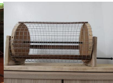
Figura 2 - Máquina de lavar mandioca
