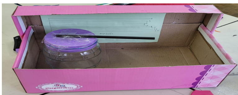
Imagem 1: Barômetro - Este barômetro é uma forma de verificar a variação da pressão do ar, entre alta e baixa.
